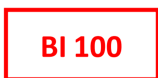
Exemples de signalisation d'une bouche incendie
